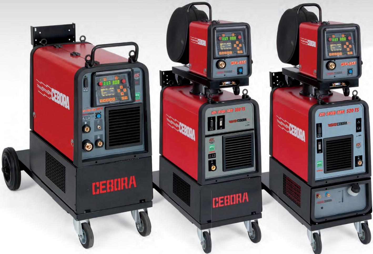
**EVO SPEED STAR** è una linea di generatori per saldatura trifase inverter multi-processo (MIG-MAG, MMA, TIG DC con sistema di accensione a contatto "Lift by Cebora"), compatti (380 TC, art. 318) o con carrello trainafilo separato (380 TS, art. 319, e 520 TS, art. 320), a controllo sinergico che permette di controllare le condizioni di saldatura per mezzo di una sola variabile, essendo tutte le altre preimpostate da Cebora e dipendenti da questa.
